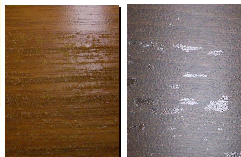
ワックス剥離剤による塗装面への影響性
