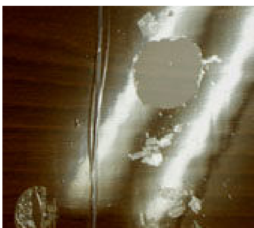
適合していないワックスを塗布した場合の耐水密着状態
